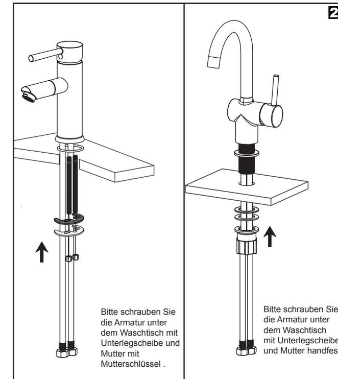
Bitte schrauben Sie die Armatur unter dem Waschtisch mit Unterlegscheibe und Mutter mit Mutterschlüssel.
