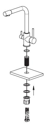
4 Schrauben Sie die flexiblen Anschlussschläuche mit den jeweiligenDichtungen an die Eckventile amWandanschluss. Achten Sie darauf, dassSie die flexiblen
